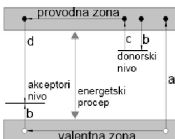
Slika 22. Dvozonski energetske model poluprovodnika: a) generisanje para elektron-šupljina; b) zahvat elektrona i šupljina u aktivatorske centrima; c) oslobađanje elektrona; d) rekombinacija.
