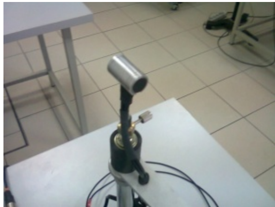
Slika V7.14 a) Hardverska realizacija sistema mikrofona sa promenljivom karakteristikom učestanosti; b) zvučnik i mikrofonski par u početnoj poziciji; c) pojačavač i pretpojačavač; d) mikrofonski par
