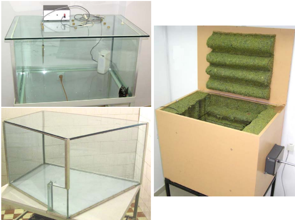
V5.1 Na slikama su prikazani fizički modeli dve reverberacione i jedne anehoične prostorije koji se nalaze u Laboratoriji za akustiku ETF.
