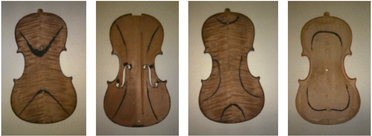
Slika VI.12 Prikaz oscilovanja prvih nekoliko rezonanci prednje i zadnje ploče violine
