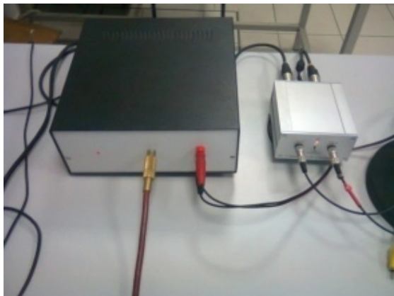
Slika V7.14 a) Hardverska realizacija sistema mikrofona sa promenljivom karakteristikom učestanosti; b) zvučnik i mikrofonski par u početnoj poziciji; c) pojačavač i pretpojačavač; d) mikrofonski par
