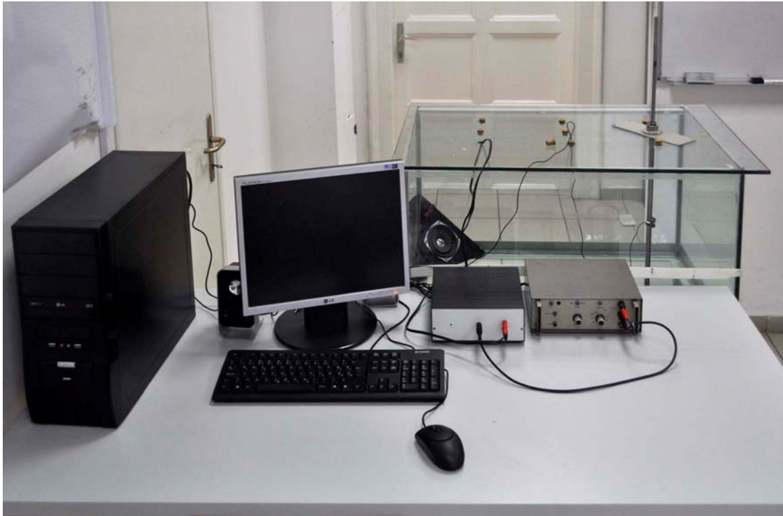
Slika V5.4. Izgled merne postavke za merenje sopstvenih rezonantnih frekvencija u modelu reverberacione prostorije
