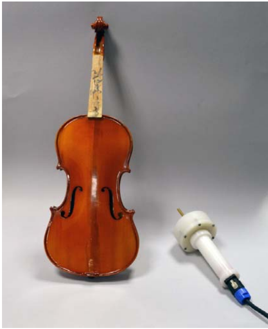
V1.11 Fotografija tela violine i mehaničkog pobuđivača koji se koriste u vežbi
