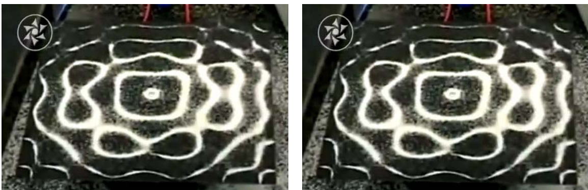
Slika V1.9 Izgled Chladni pattern-a na ploči za dve različite frekvencije rezonance.
