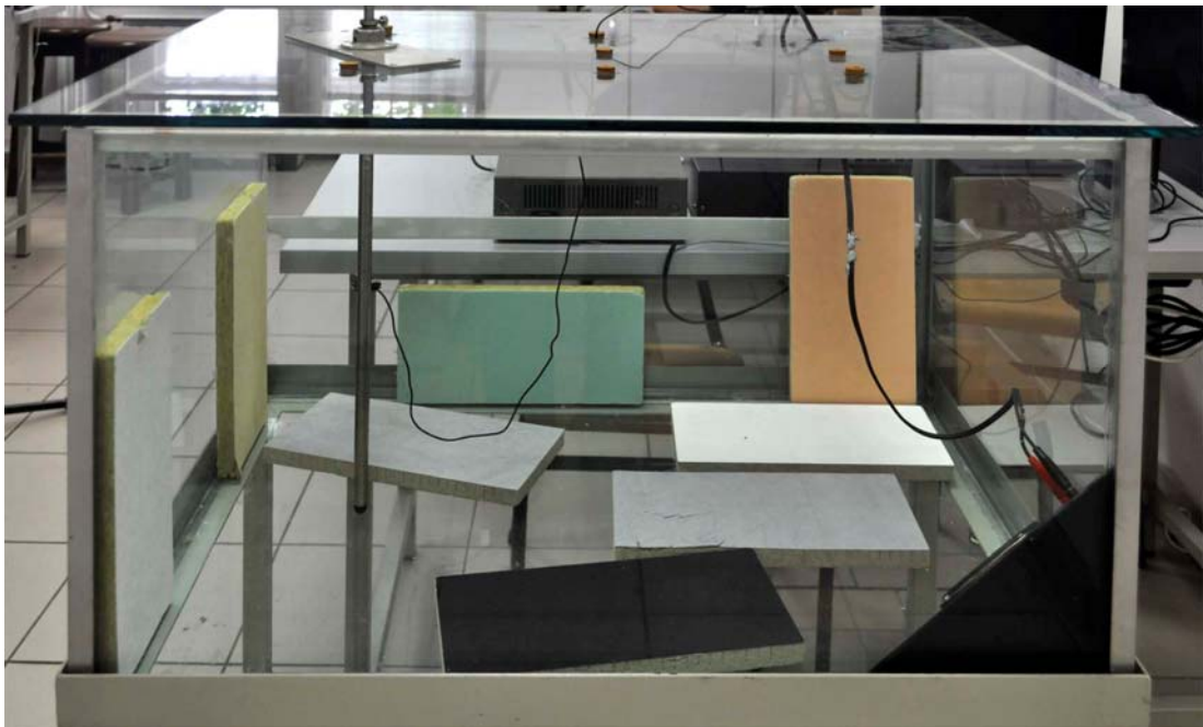
Slika V5.6 Primer merne postavke apsorpcionog materijala u komori.
